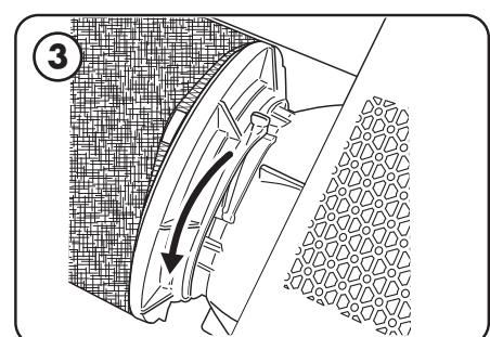
Dégarez le levier de serrage du filtre jusqu'à ce qu'un déclique se fasse entendre.
