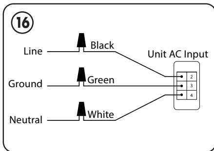
Demandez à un électricien qualifié de connecter la mise en terre, la ligne électrique et le neutre à l'appareil conformément aux codes en vigueur.
