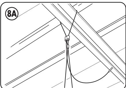
Passez l'extrémité des câbles de fixation à travers les supports ou le matériel prévu.
