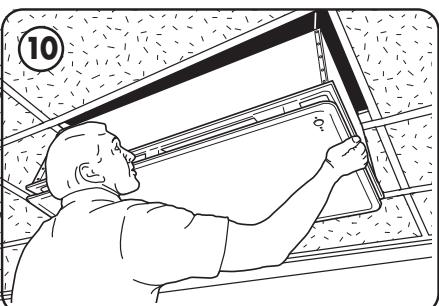
Demandez à une ou deux personnes de soulever lentement l'appareil pendant qu'une autre tire l'extrémité des câbles afin de les maintenir tendus pendant l'élévation.
