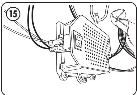
Assurez-vous que l'interrupteur d'alimentation situé sur le bloc d'alimentation est en position d'arrêt avant de procéder au raccordement des fils.
