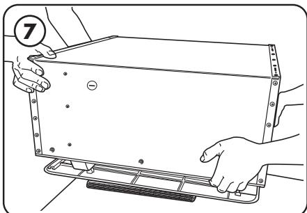
Soulevez et faites pivoter l'appareil avant de le placer, côté porte vers le bas, sur les supports fournis. Déterminez quelle passage électrique sera utilisée et retirez la pièce afin d'en libérer l'orifice.
