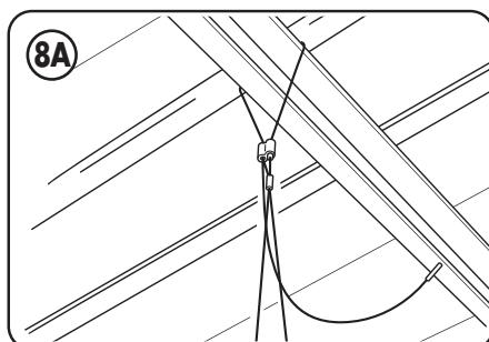
Enrolle el extremo abierto de los cables a través del soporte o equipo previsto.
