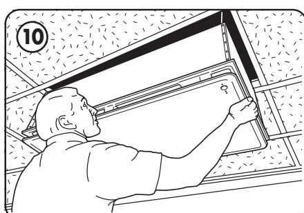
Pida a una o dos personas que levanten lentamente la unidad, mientras la otra tira del extremo libre de los cables para mantenerlos tensos.
