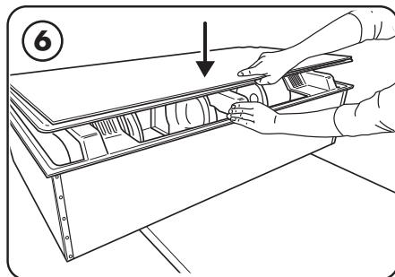
Cierre la puerta hasta que escuche un clic. Según el tipo de plafón, fije los accesorios de montaje correctos por sobre el área de la instalación, según las normas locales para soportar una unidad de 92 lb (42 kg). Preferiblemente, la ubicación de los montajes formará un rectángulo de 23" x 46".
