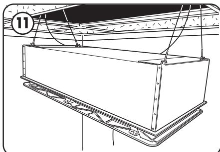
Soulevez l'appareil jusqu'à ce que le haut du boîtier soit juste en dessous de la grille.
