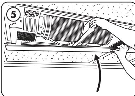
Fermez la porte de l'appareil jusqu'à ce que vous entendiez un déclic. Après avoir fermé la porte, appuyez sur la porte fermée sur les coins et directement sous le dispositif de verrouillage pour vous assurer que les aimants et le dispositif de verrouillage sont bien fixés.
