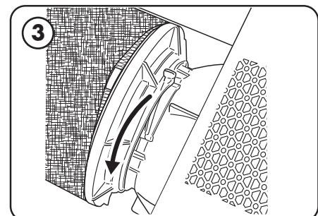
Desenganche la palanca de sujeción del filtro hasta que escuche un clic.
