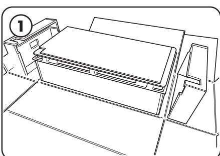
Avant de commencer l'installation, assurez-vous qu'un électricien qualifié a installé un circuit de 120 V dans la zone d'installation. Retirez l'appareil de son emballage et placez-le sur une table ou une surface, sous ou à proximité de la zone d'installation, la façade orientée vers le haut.
