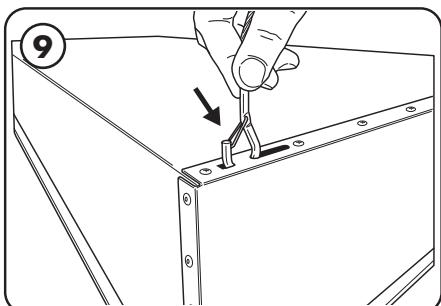
Fixez les crochets fournis aux câbles à travers les trous de fixation.
