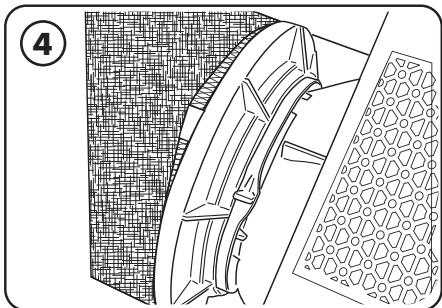
Remettez le filtre en place en remettant le levier de serrage du filtre en position verrouillée jusqu'à ce qu'un déclic se fasse entendre.
