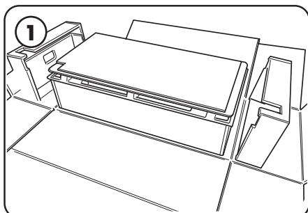
Antes de comenzar la instalación, asegúrese de que un electricista calificado haya instalado un circuito de 120 V en el área de la instalación. Retire la unidad del embalaje y colóquela con la puerta hacia arriba sobre una mesa u otra superficie bajo el área de la instalación o cerca de ella.
