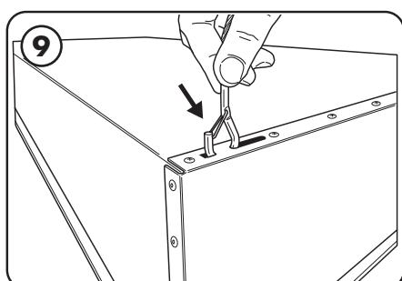
Fije los ganchos de las cuerdas de alambre a la carcasa, a través de los orificios de montaje.
