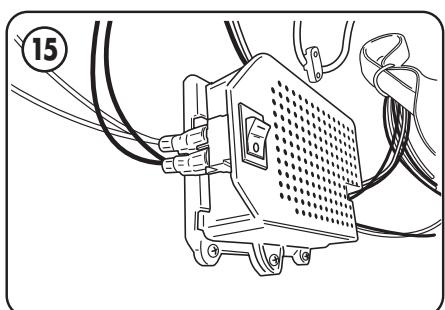
Antes de proceder a conectar cualquier cable, asegúrese de que el interruptor de alimentación ubicado en la fuente de alimentación esté en la posición de apagado.
