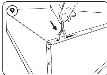
Fije los ganchos de las cuerdas de alambre a la carcasa a través de los orificios de montaje (P7).
