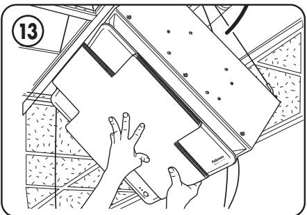
Faites pivoter et soulevez complètement à travers la grille jusqu'à ce que l'appareil soit redressé au-dessus de l'élément plafonnier en vous assurant que le panneau inférieur n'est pas endommagé.
