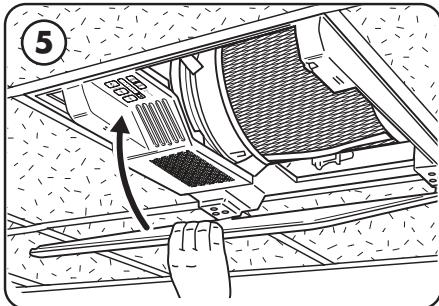
Cierre la puerta hasta que escuche un clic. Después de cerrar la puerta, presiónela para cerrarla en las esquinas y directamente debajo del pestillo para asegurarse de que los imanes y el pestillo estén completamente asegurados.
