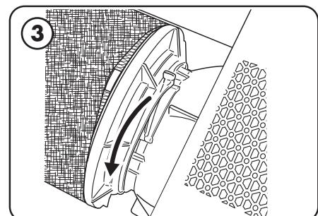
Dégarez le levier de serrage du filtre jusqu'à ce qu'un déclic se fasse entendre.
