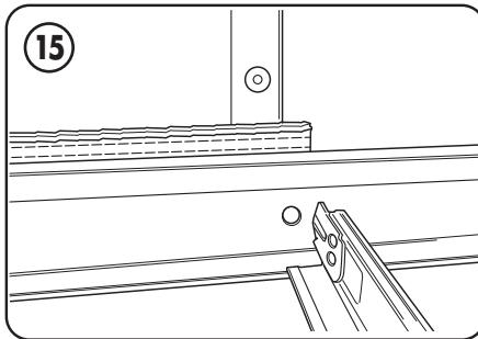
Vérifiez que le dessous de l'appareil ne présente pas de défauts. Si nécessaire, ajoutez des blocs de centrage entre l'unité et la grille. Découpez tel que souhaité.
