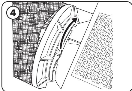
Fije el filtro en su lugar moviendo la palanca de la abrazadera del filtro a la posición de bloqueo hasta que escuche un clic.
