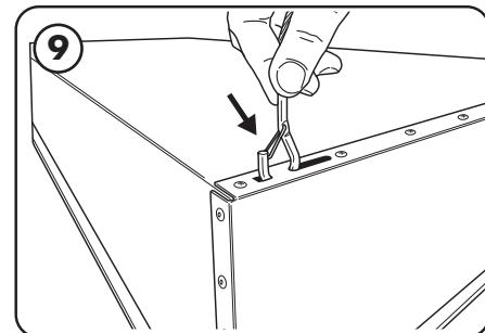
Fixez les crochets des câbles fournis au boîtier à travers les trous de fixation (P7).
