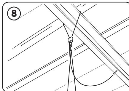
Passez l'extrémité des câbles de fixation à travers les supports ou le matériel prévu. Utilisez les verrous fournis pour câbles afin de bien sécuriser chaque câble.
