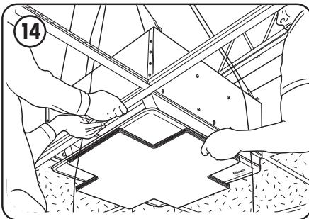
Alors qu'une personne supporte l'appareil qui frôle la grille, l'autre doit tirer les câbles en suspension jusqu'à ce qu'ils soient tendus.
