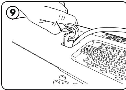
Fije los ganchos del cableado de la aeronave provisto a la carcasa a través de los orificios de montaje.
