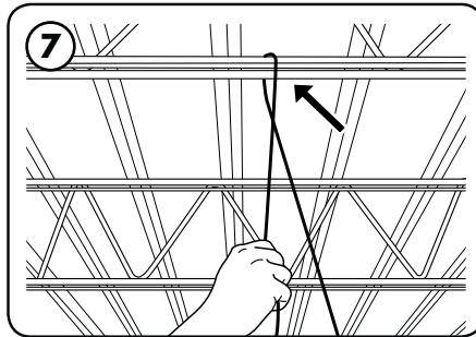
Selon le type de plafond, fixez le matériel de montage approprié au-dessus de la zone d'installation à des distances appropriées, conformément aux réglementations locales pour supporter un luminaire de 45 lb (21 kg).
