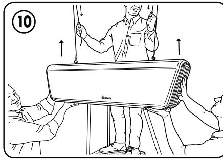
Pida a dos personas que levanten lentamente la máquina mientras la otra tira del extremo libre de los cables para mantenerlos tensos. Alterne al levantar lentamente cada lado para mantener la unidad relativamente equilibrada durante el levantamiento.
