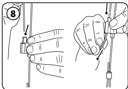
Bouchez l'extrémité ouverte des câbles à travers la ferme prévue.
