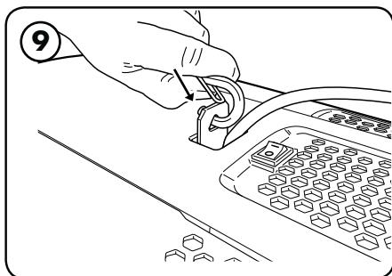
Fixez les crochets du câblage d'avion fourni au boîtier à travers les trous de montage.
