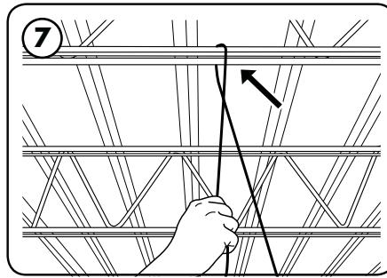
Según el tipo de techo, fije las herramientas de montaje adecuadas sobre el área de instalación a las distancias adecuadas según las normas locales para soportar un dispositivo de 45 lb (21kg).
