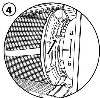
Fixez le filtre en place en déplaçant le levier de serrage du filtre en position verrouillée jusqu'à ce qu'un déclic se fasse entendre.
