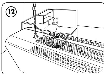
Enrolle y envuelva el cable restante para apartarlo. No recorte los tramos de cable sobrantes. Retire las bandejas de soporte de la parte inferior de la unidad y deséchelas.
