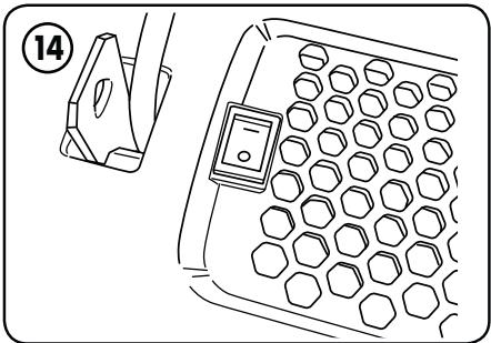
Mettez l'interrupteur d'alimentation sur la position ON ("I"). Pour terminer l'installation, installez les filtres selon les instructions ci-dessous.
