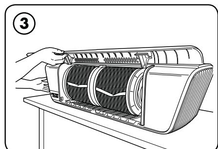
Ouvrez la porte de l'appareil en décollant le ruban adhésif au besoin et en tirant doucement vers l'extérieur sur le bas du panneau de la porte.
