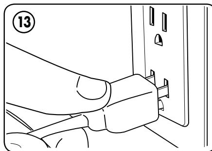
Enchufe la unidad en el tomacorriente preinstalado.
