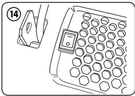
Coloque el interruptor de encendido en la posición de ENCENDIDO ("I"). Para completar la instalación, instale los filtros según las instrucciones a continuación.
