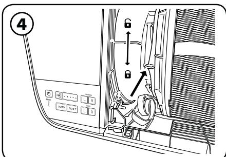
Desenganche cada palanca de sujeción del filtro hasta que se escuche un clic.
