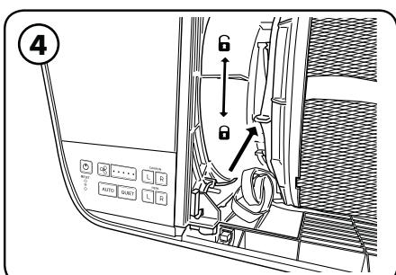
Désengagez chaque levier de serrage du filtre jusqu'à ce qu'un déclic se fasse entendre.
