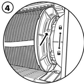
Asegure el filtro en su lugar al mover la palanca de sujeción del filtro nuevamente a la posición de bloqueo hasta que se escuche un clic.
